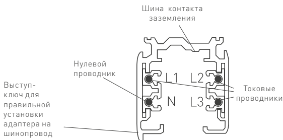
Рисунок 1. Конструкция шинопровода.
